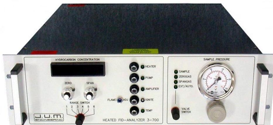
Das Analysenteil des Analysators entspricht vollständig der EN 14181/EN ISO 14956, EN 12619: 2013, EN 13526 in der EU und der EPA-Methode 25A und 503 in den USA.
